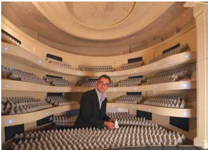
Akustikmodell im Maßstab 1:10: Hier maß der Autor die Schallabsorption der Bestuhlung, um sie an die Anforderungen anpassen zu können
