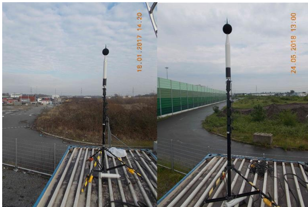
Abbildung 31: Messpunkt Containerterminal (Dauermessung): vor (links) und nach (rechts) Errichtung der Lärmschutzwand (Quelle: Peutz Consult)
