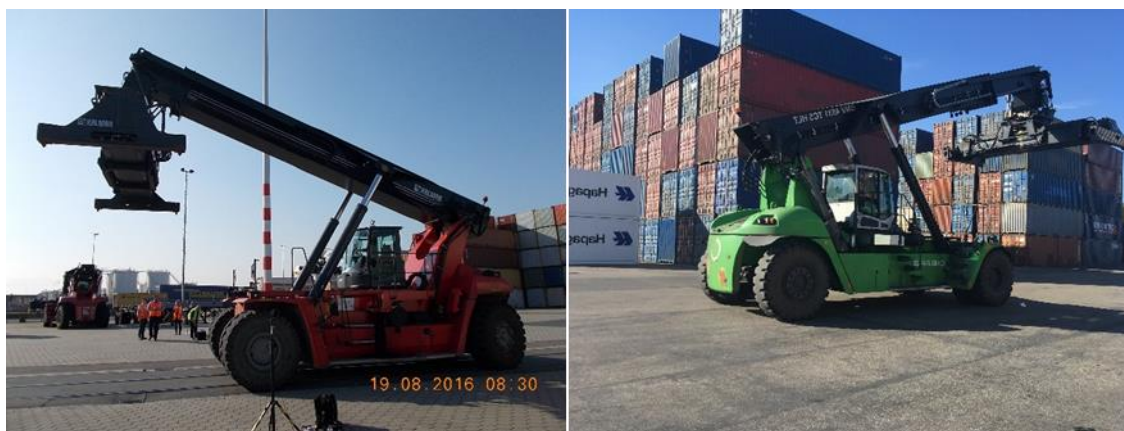
Abbildung 24: Reachstacker mit Dieselantrieb (links) und hydrostatischem Antrieb (rechts) (Quelle: Duisburger Hafen AG 2017b)
