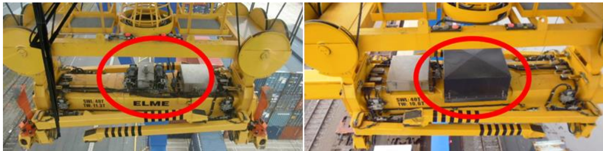
Abbildung 21: Kapselung des Hydraulikaggregates am Kran-Spreader (ohne links und mit rechts Kapselung) (Quelle: Peutz Consult)
