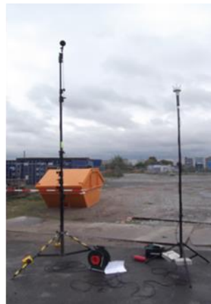
Abbildung 18: Messanordnung gemäß der Richtlinie über zulässige Schallimmissionen von Containerkranen der DB AG, Messung 1 (Quelle: Eigene Darstellung Peutz Consult)
