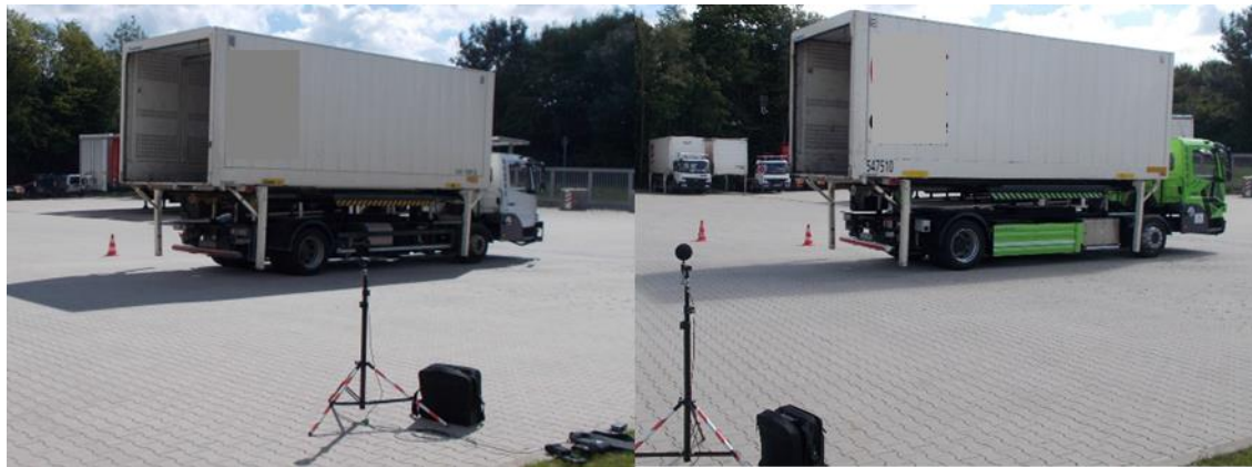
Abbildung 27: Umsetzer-Lkw mit Dieselantrieb (links) und mit elektrischem Antrieb (rechts) (Quelle: Duisburger Hafen)
